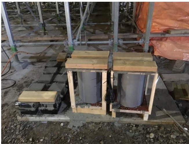
Figuur 3.14 Cilinders en kubussen op bouwlocatie [L] en meetopzet laboratorium [R]
